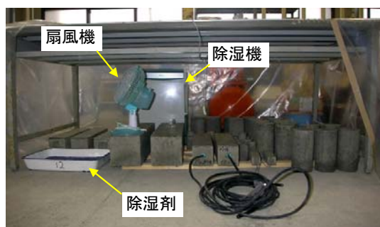
写真-2 湿度 40%制御の養生装置
