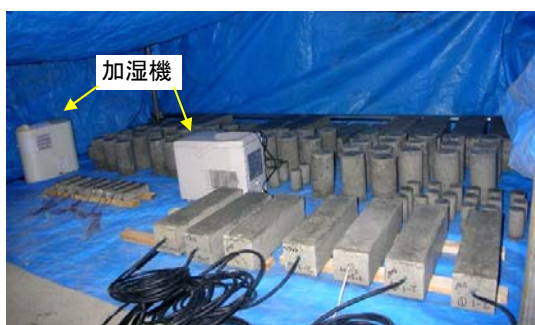
写真-1 湿度 95%制御の養生装置
