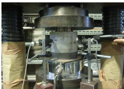
図-2 ひび割れの導入状況
