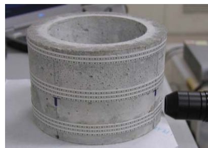
図-3 ひび割れの測定位置
