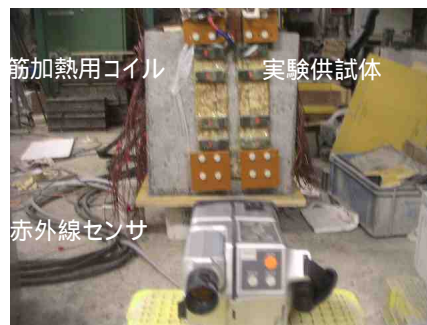
図 - 1 劣化診断システムの概要図
