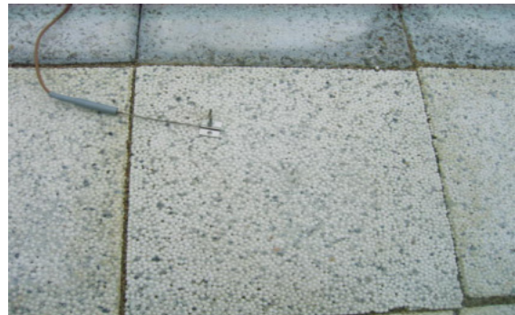
図-2 屋外暴露試験の熱電対固定風景
