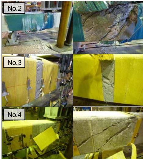
図-10 終局時の破壊状況
