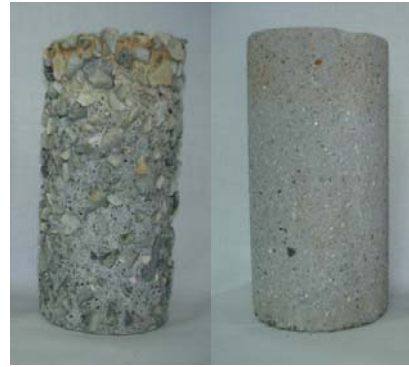
普通コンクリート B BFF コンクリート A 写真-3 温泉水中に 1 年間浸漬した供試体
