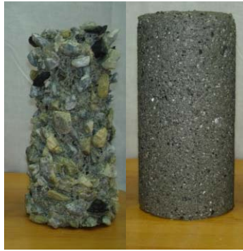
普通コンクリート B BFF コンクリート No. 2 写真-2 10%硫酸溶液に 56 日浸漬した供試体
