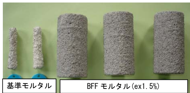
写真-1 10%硫酸溶液浸漬後(56日)のモルタル供試体 (実験 2)
