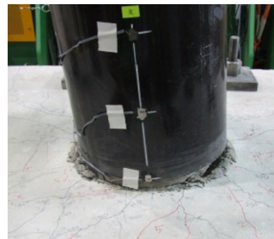
写真三 K7 試験体最大荷重付近の状況
