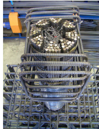
写真一 試験体の配筋状態の例
