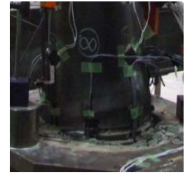
7δy : 部材角 1/6 写真-4 T-9 試験体
