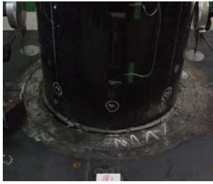
3δy : 部材角 1/20 写真-1 T-6 試験体
