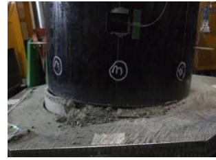
7δy : 部材角 1/8 写真-3 T-8 試験体
