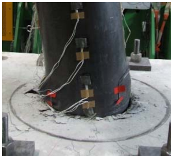
6δy : 部材角 1/6 写真-5 k-13 試験体
