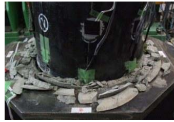
4δy : 部材角 1/10 写真-2 T-7 試験体
