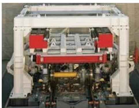
図-3 実物台車を用いた加振試験装置の構成
