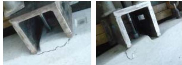
図-17 PCまくらぎ、鋼製インサートの破壊状況
