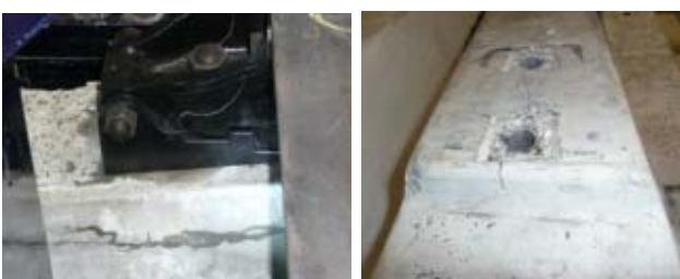
図-20 静的水平載荷試験での PC まくらぎの破壊状況
