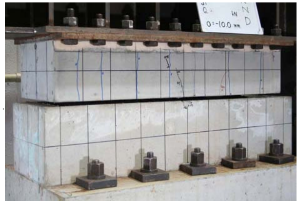
写真-1 最終破壊状況 (45C10)
