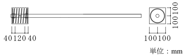
図-13 片引き付着実験供試体形状
