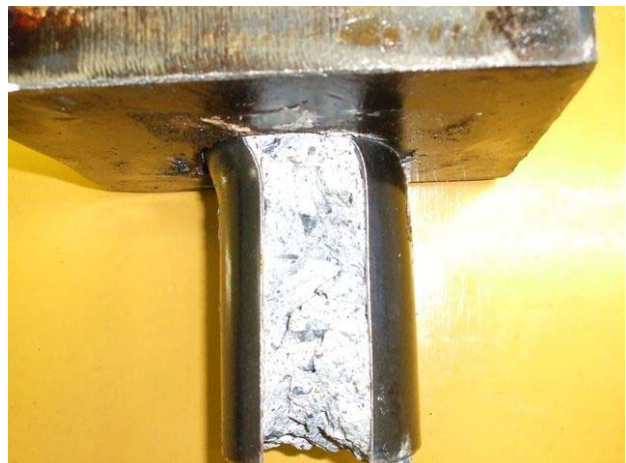
写真 - 6 載荷試験後の変形性状 (その 2)
