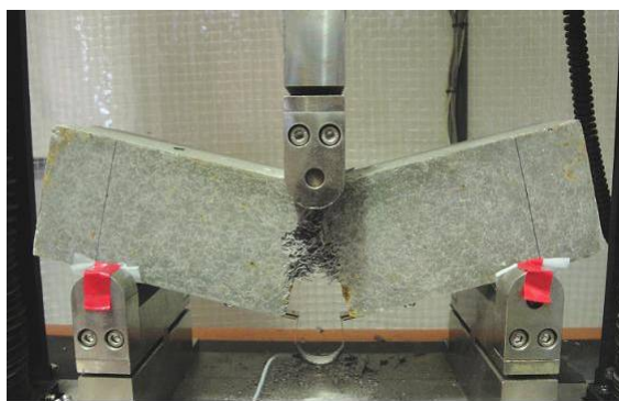
図-13 HVFC を用いた切欠きはりの 3 点曲げ試験
