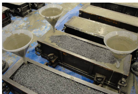
図-2 HVFC の製造 (プレパックド鋼繊維とグラウト注入)
