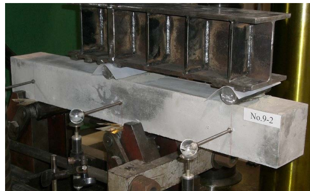
写真-1 せん断試験状況 (シアスパン比 0.125 の場合)
