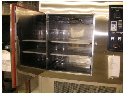
図-2 蒸気養生装置
