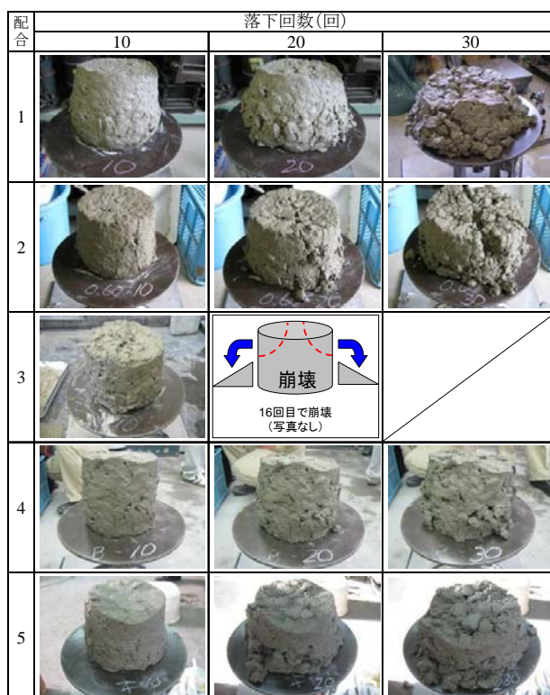
写真-4 変形抵抗性試験時の状況
