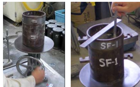
写真-2 締固め性試験
