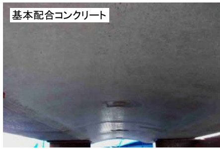
(a) 下面(覆工の仕上がりり面である表面側に相当。写真の奥が打込み箇所、手前が流動先端)
