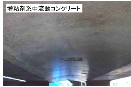
(a) 下面(覆工の仕上がりり面である表面側に相当。写真の奥が打込み箇所、手前が流動先端)
