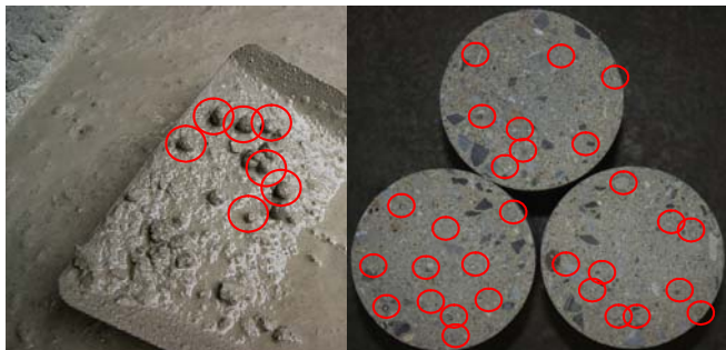
写真-5 コンクリート中に確認されたSH材料造粒物
