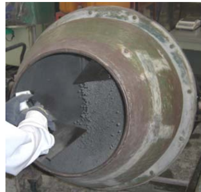
写真-1 傾胴式ミキサを用いた転動式造粒の様子
