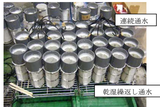
写真-3 円柱供試体を用いた通水試験の様子
