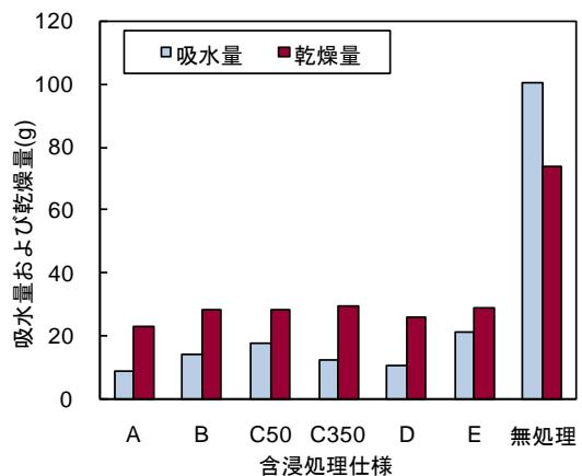
図-5 吸水量および乾燥量
