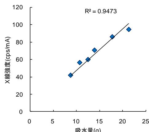
図-8 吸水量とX線強度の関係
