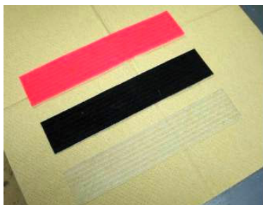
図-10 顔料により着色したFRPプレート
