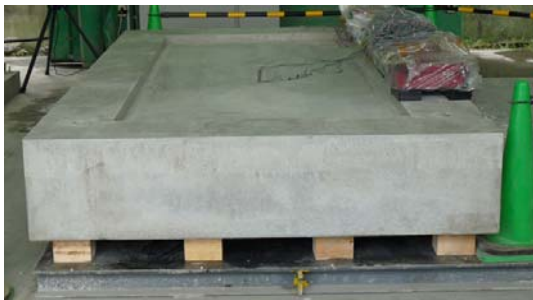
図-2 梁付スラブ試験体
