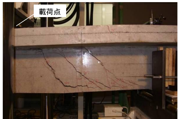
図 - 3 No.1 実験終了時の状況 (側面)
