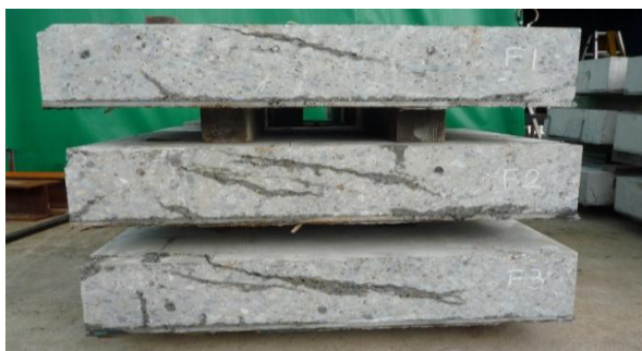
図-18 供試体切断状況 切断線② (上から I-300-F01, I-300-F02, I-300-F03)
