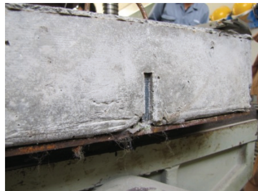
(d) 底鋼板とコンクリートのすべり (H-S-2 供試体)
