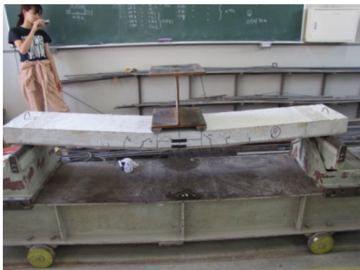
(c) 破壊状況 (F-SR-2 供試体)
