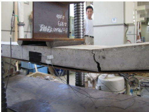
(a) 破壊状況 (H-N-1 供試体)
