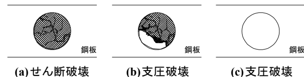
図-5 PBLの破壊状況
