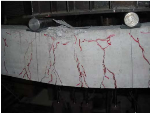
写真-3 載荷試験後の NC 供試体
