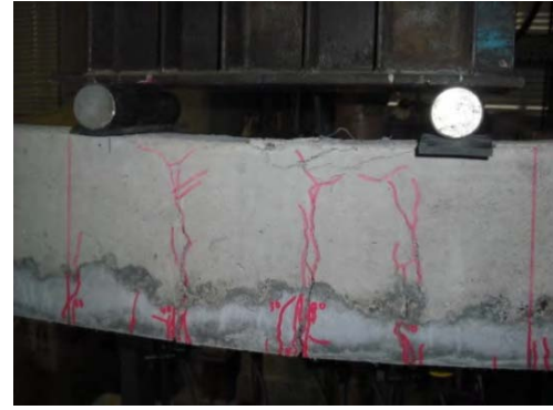
写真-4 載荷試験後の NC-HP 供試体
