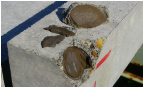
写真－2 千歳5-川砂利(b)60口の剥落
