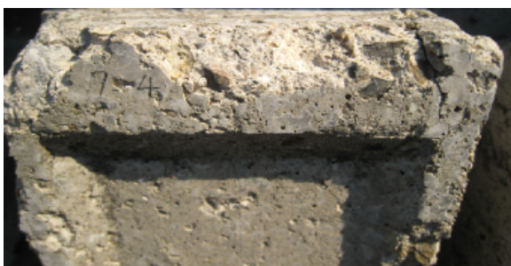
写真－4 つくば7-ローモン(c)60凹の劣化
