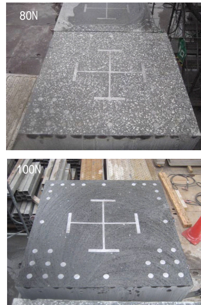
写真-5 充填状況(柱高さ2m切断面)
