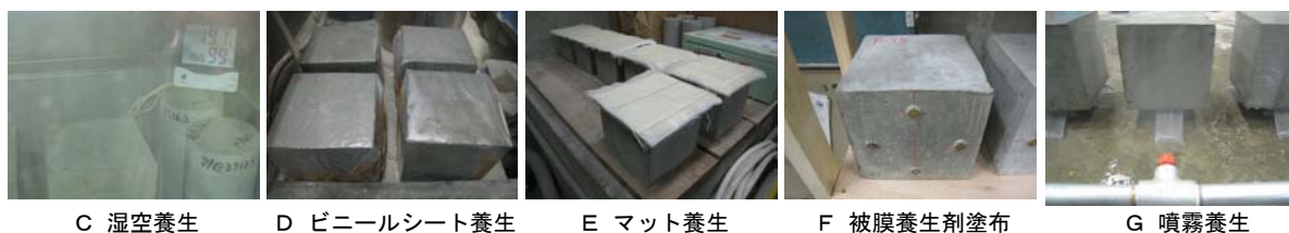
写真-1 湿潤養生実施状況
