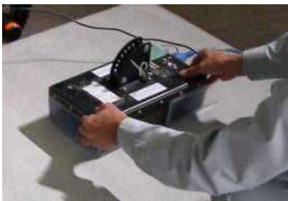
写真 - 4 地中レーダ探査装置による測定状況
