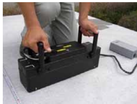
写真 - 2 センサアレイ型超音波探傷装置での測定状況
