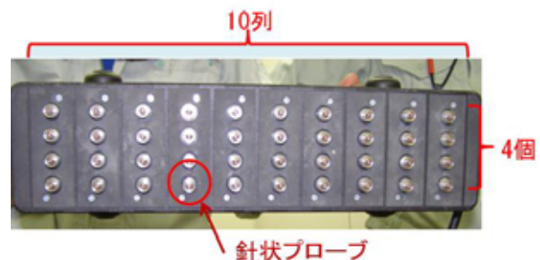
写真 - 3 針状プローブを配置した超音波アレイセンサ
