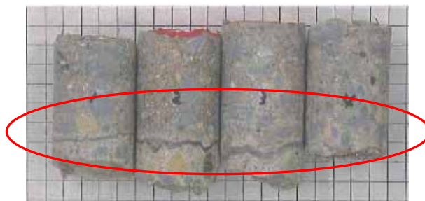
写真 - 3 樹脂注入後の充填状況
