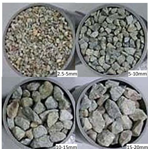
図-2 締め固めた砕石の様子
