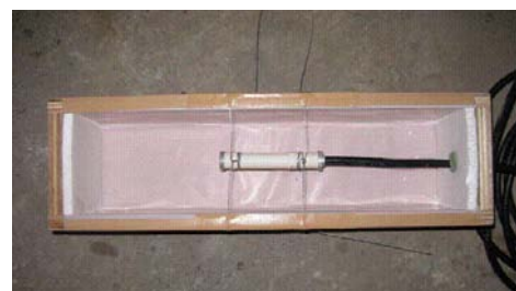
写真-3 ひずみ計の設置状況
