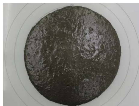
写真－4 フロー試験後の状況
