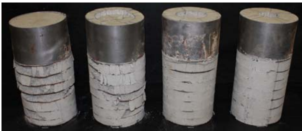
(a) φ6の帯筋モルタル (L=100mm)
