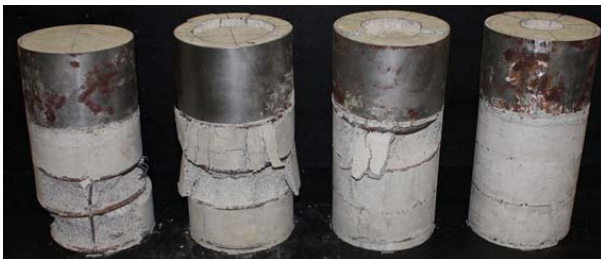
(b) φ9の帯筋モルタル (L=100mm)
