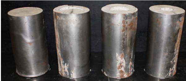
写真-2 鋼管モルタルの最終破壊状況 (左から支圧径(B)=145, 100, 75および50mm)
