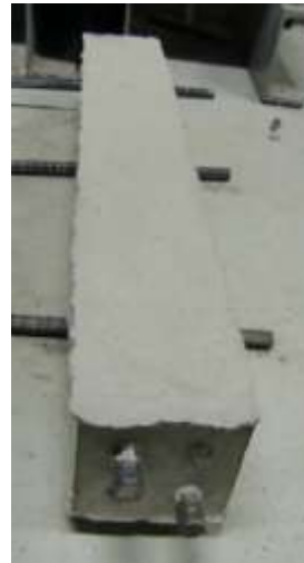
写真-1 (左) 拘束ひび割れ試験体
