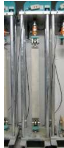
写真-1 (左) 拘束ひび割れ試験体
