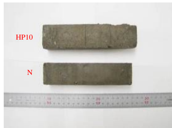
写真-2 膨張したモルタル(上: HP10, 下: N)
