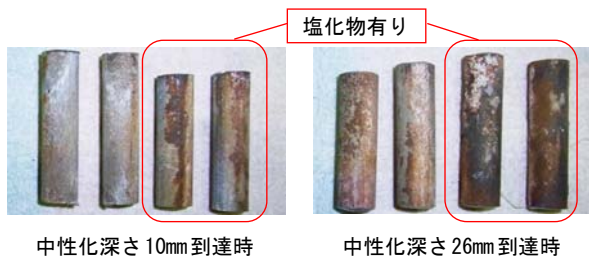
図-9 鉄筋表面の発錆状況 (W/C=80%, 60°C60%RH)
