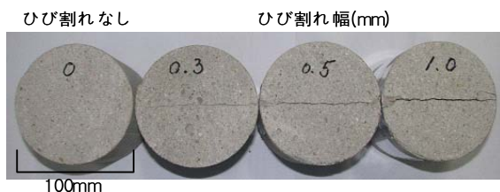
図-3 モルタル試験体のひび割れ発生誘導状況
