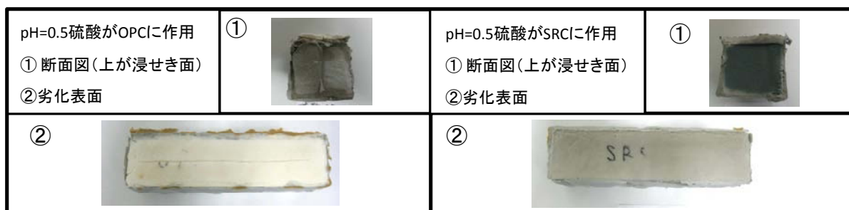
写真-2 供試体の劣化状況 (pH=0.5 硫酸)
