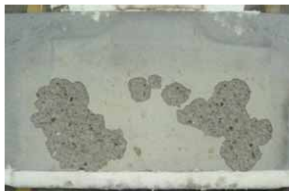
写真 - 5 a-2 試験体の加熱後状況 (800 加熱, PP 繊維未混入, 高強度コンクリート配合)
