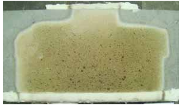
写真 - 2 a-1 試験体の加熱後状況 (1200 加熱, PP 繊維混入, 高強度コンクリート配合)
