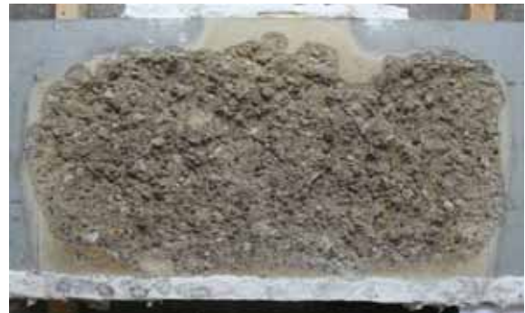
写真 - 3 a-2 試験体の加熱後状況 (1200 加熱, PP 繊維未混入, 高強度コンクリート配合)
