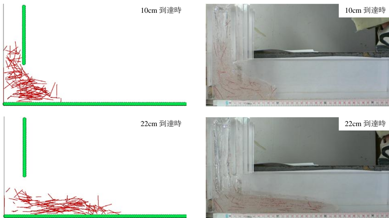
図-10 モデルモルタルの流動性状 (鋼繊維) (左: 解析結果 右: 実験結果)
