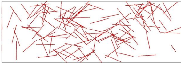
図-12 モデルモルタルの流動性状(鋼繊維, 平面) (上: 実験結果 下: 解析結果)
