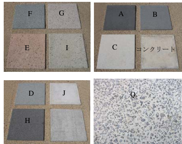
写真-2 コンクリートブロック (A~J) の外観およびカキ殻粉入りモルタル充填供試体 (Q) の表面の模様
