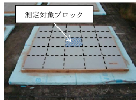
図-2 舗装材料曝露の様子
