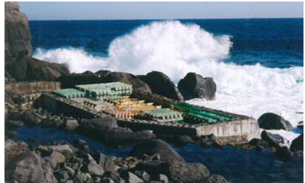
写真-2 海洋暴露試験場
