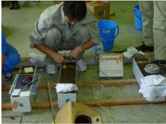
写真-3 電気化学的測定状況
