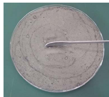
写真-2 可使時間実験の方法
