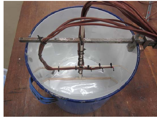
写真-1 型枠および熱電対の設置状況
