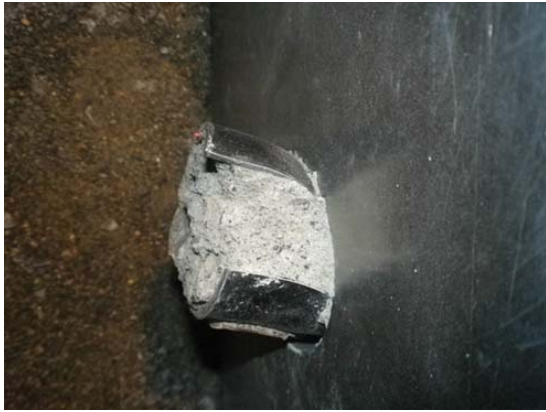
写真-1 鋼パイプの局部変形
