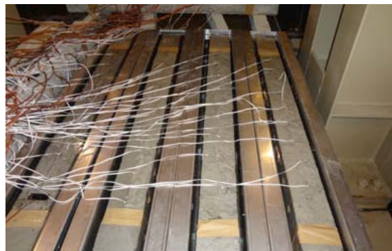
図-4 凍結融解試験状況
