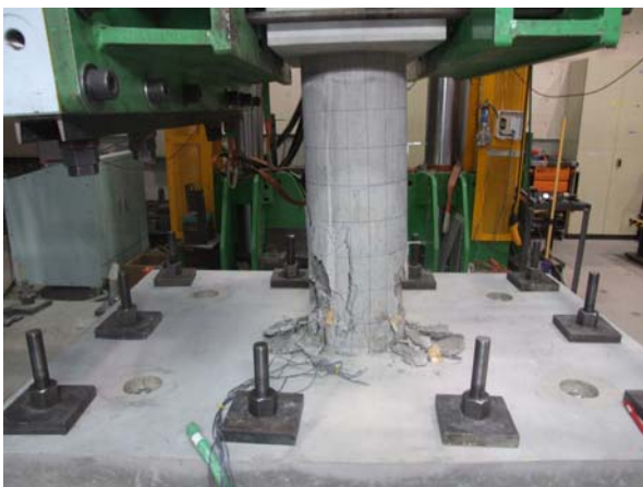
図-3 No.1 1/33 荷重後の状況
