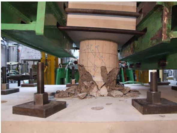
図-8 No.3 1/12.5 載荷後の状況
