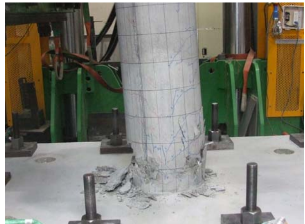
図-5 No.2 1/20 荷重後の状況
