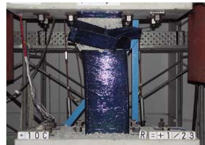
CCA-6-1 (シートが破断した)
