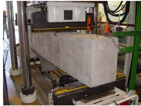
写真-3 No. 1 供試体破壊状況
